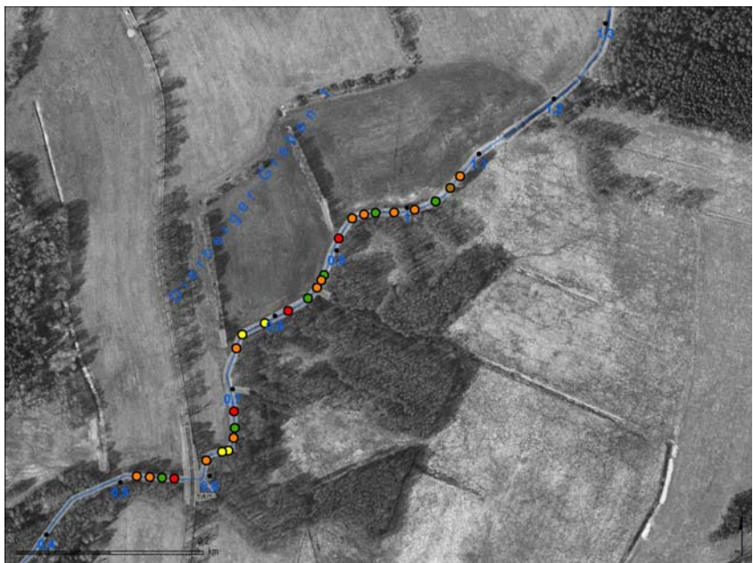
Naturnahe Einbauten des Gewässerunterhaltungsverbandes ● Baumstübe/Stamm ● Findling ● Flügelbuhne ● Pfahlbuhne ● Totholzrechen ● Grundschwelle — Fließgewässerachse mit Stationierung — Gewässervermessung MEG 2008 Quelle: FPB GmbH, MEG
